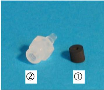
Setzen Sie die Dichtung ① und den Schlauchverbinder ② (Umrüstsatz Schlauchanschluss PeriClip für Messkammeraufnahme Art.-Nr. 40359) wie folgt in die Messkammeraufnahme ein:
